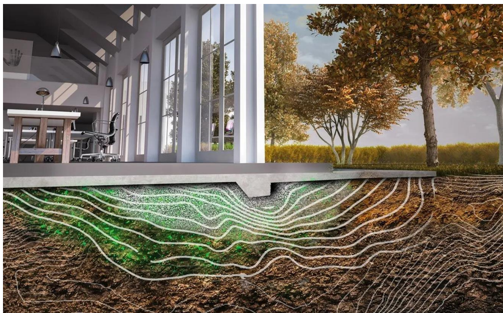
Рис. 4. Усиление грунтового основания микробиологической цементацией
